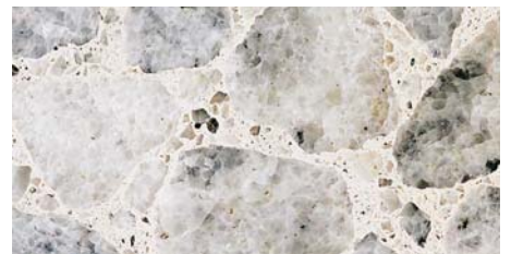
Slipt og polert betongoverflate av hvit Hustad marmorsingel i hvit betong av hvit sement og hvit tilslag.
