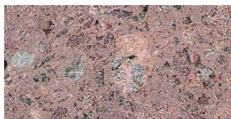
Grovt slipt betongoverflate av rød Drammensgranitt i rød fargepigmentert betong.
