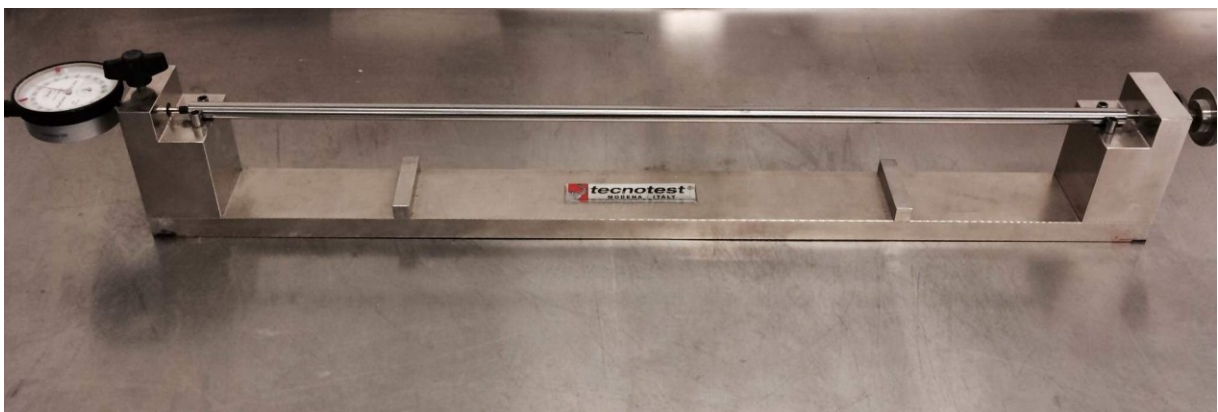
Figur A-2: Lengdemålingsrigg med 500 mm referansestav
