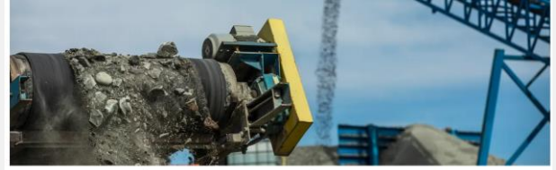
Forurenset masse sorteres og vaskes på Rimol Miljøpark. Det er disse fraksjonene som nå blandes inn i Betong Østs nye Betong. (Foto: AF Gruppen/Catchlight)
